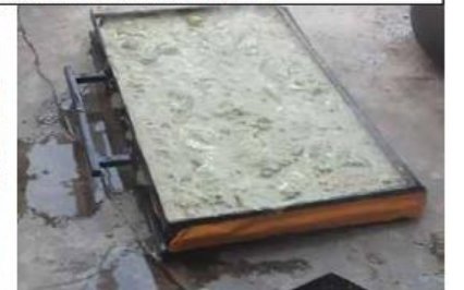
Proses pencetakan sampah plastik menjadi panel material dinding
