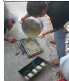
Proses pencetakan sampah plastik menjadi panel material dinding
