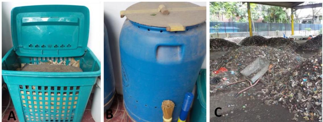
Gambar 4.2. Berbagai Metode Pengomposan yang Dapat Dilakukan pada Skala Rumah Tangga dan Skala Kawasan. A) Metode Pengomposan dengan Keranjang Takakura, B) Metode Pengomposan dengan Drum Komposter, C) Metode *Windrow Composting*.
